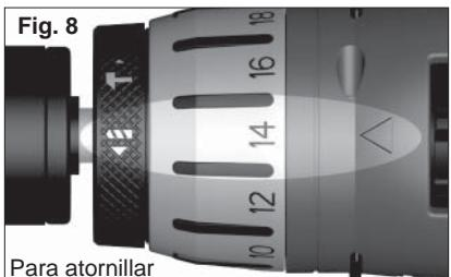
El embrague ajustable, cuando está bien ajustado, patinará al par de torsión preestablecido para impedir que el tornillo entre demasiado en diferentes materiales y para impedir dañar el tornillo o la herramienta.
